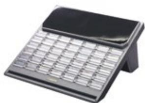
предназначен для увеличения количества кнопок пульта DIS-TOP
