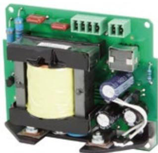
Если производственная обстановка требует большую громкость принимаемых сообщений, чем та, которую обеспечивает встроенный усилитель, в DW/DWEx может устанавливаться дополнительный усилитель мощностью 25 Вт.
