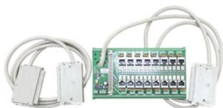
Модуль резервирования центрального коммутатора DCN-2 предназначен для обеспечения работоспособности системы связи DCN в случае возникновения аварии в центральном коммутаторе DCN-2 за счет автоматического подключения резервного коммутатора DCN-2 вместо неисправного.
