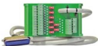
Кабель подключения DCN-15A служит для подключения к модулю аналоговых интерфейсов аналоговых линий абонентских устройств, потока E1 и дискретных линий управления.
